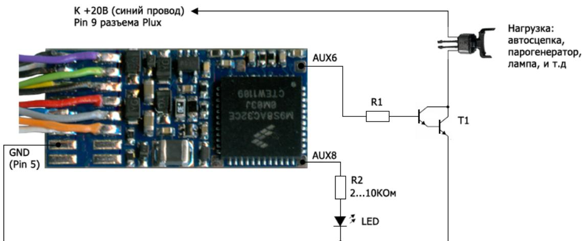
Сопротивление резистора R2 зависит от требуемой яркости подключаемого светодиода, чем больше резистор тем меньше будет яркость. Обычно подходит резистор номиналом 2...10К. Также яркость этого светодиода можно настроить при помощи CV.
